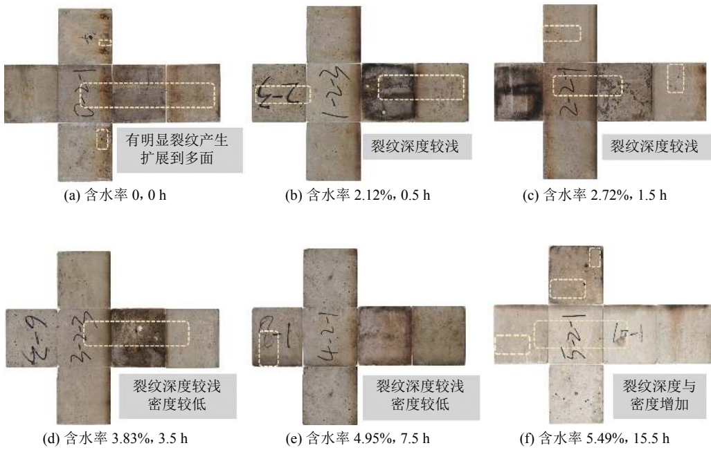
图 8 5 kW、300 s下混凝土试块在不同含水率下的加热效果
