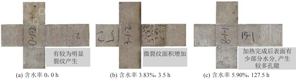
图 7 3 kW、300 s下混凝土试块在不同含水率下的加热效果
