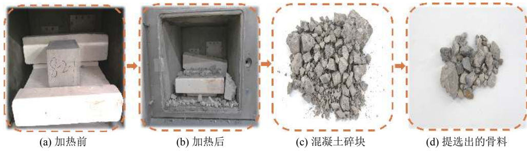
图 9 饱和试块在5 kW、300 s加热路径下破碎过程
