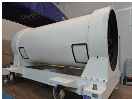
图 8 700 mm 平行光管图 Fig.8 700 mm parallel light tube
