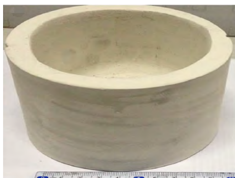
图 5 注凝成型 AlN 坯体 [66]
