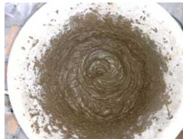
(c) 水泥土拌合物
