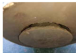
(b) 螺旋叶片竖向投影直径 91.4 \text{ mm}
