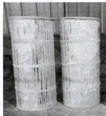
图4 采用诱导喷嘴时滤筒的堵塞情况
