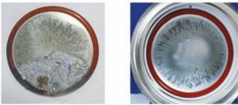
(a) 失效模块芯片 (b) 温度循环试验芯片 图2 元件芯片解剖分析图 Fig. 2 Anatomical analysis diagram of device chip
