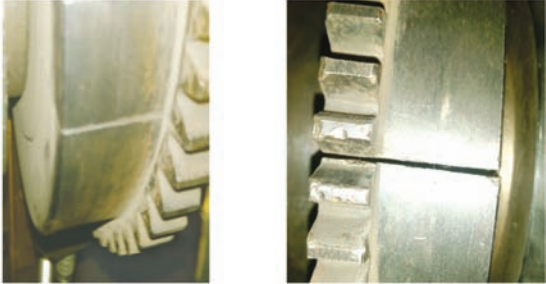
(a) 计数齿轮盘松动前的状态 (b) 计数齿轮盘松动后的状态 图 6 计数齿轮盘松动前后的图片 Fig. 6 Pictures of the count gear plate before and after it loosening
