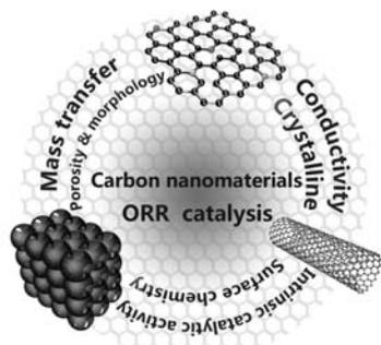
图3 碳质材料在氧还原中作用示意图
