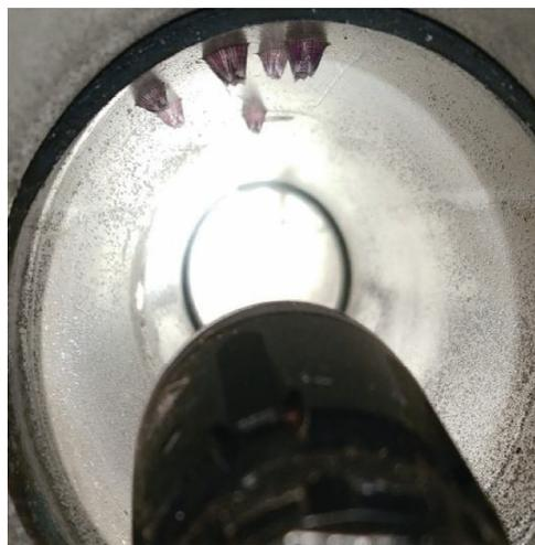
图 4 使用 3 个月后未清洗的海水管路
