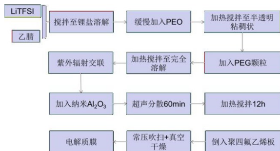
图 1 PEO-PEG-Al 2 O 3 电解质的制备流程
