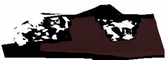
图 8 布尔干涉运算后的 4 煤、5 煤实体模型 Figure 8 4-coal and 5-coal solid model after boolean operation
