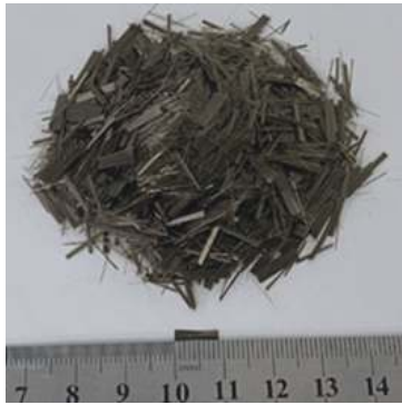
图 2 玄武岩纤维(长度为 9 mm,直径为 13 μm)
