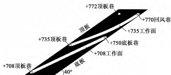
图 1 +735 工作面巷道布置剖面
